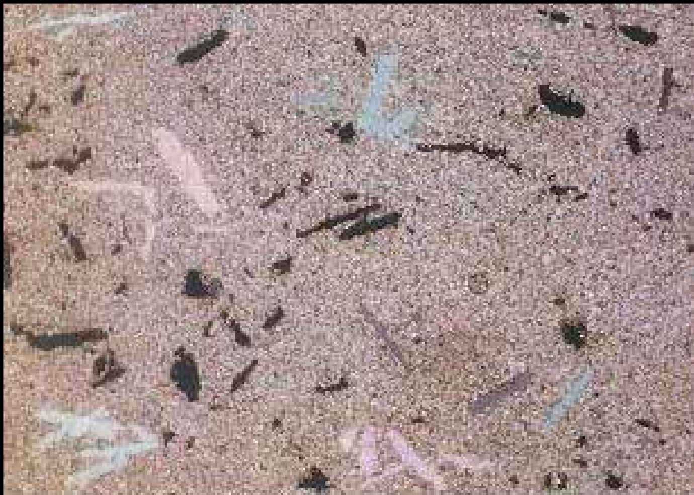
古风化壳型储层 泥晶灰岩 板状膏盐假晶和晶溶孔，基 质为泥晶方解石，正交偏光， \times 25 。 奥陶系马家沟组，河北省晋22井1357.0 ~1360.0m。
